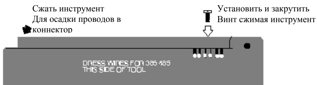
Рис.95 Запрессовка проводов и установка винта крышки.
